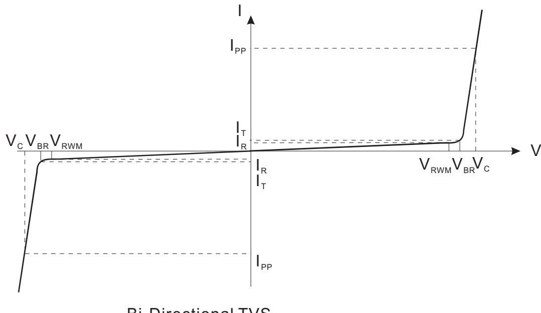
$V_C$  : Clamping Voltage @  $I_{PP}$
